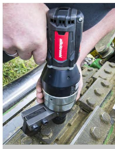
Repetir la precisión de desconexión ±3% (misma conexión con pernos). Todos los multiplicadores de par **alkitronic®** disponen de la certificación CE.
