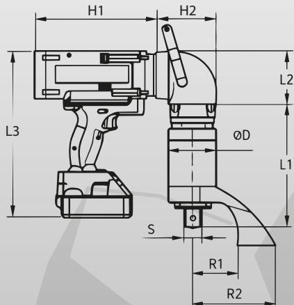
La serie BTWA es una llave de torque angular a batería de una velocidad, ideal para aplicaciones en espacios reducidos o de difícil acceso.
